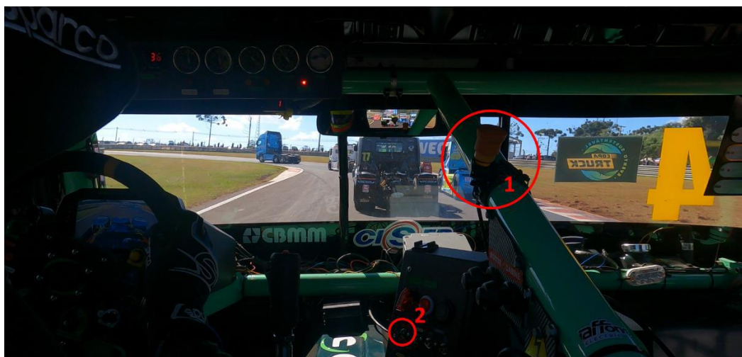
(1) Chave de Corte Geral (Kill Switch) dentro da cabine; (2) Chave de habilitação do sistema híbrido elétrico dentro da cabine.
