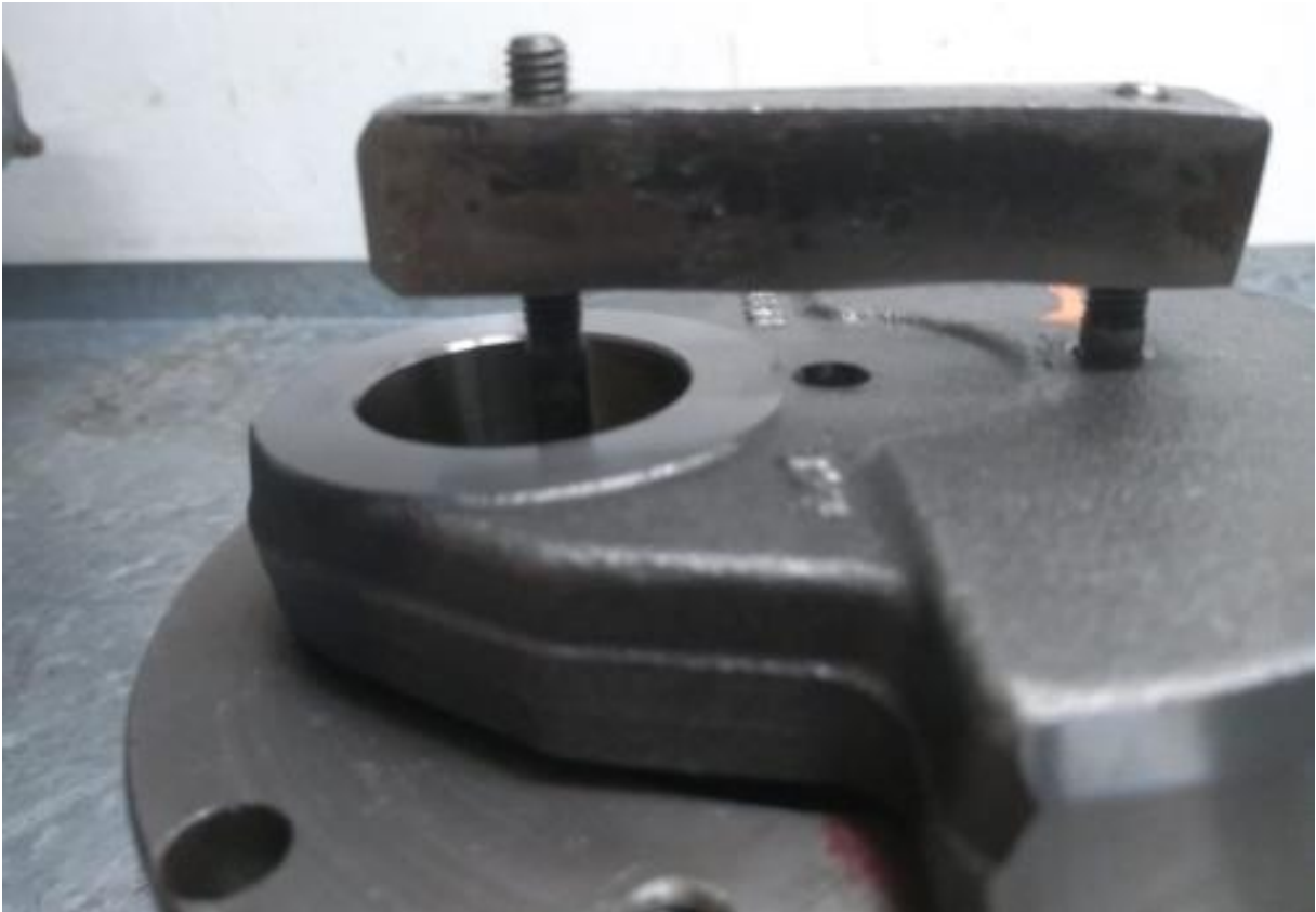
Imagem 6 – detalhe do saque da engrenagem com auxílio do furo e da ferramenta
