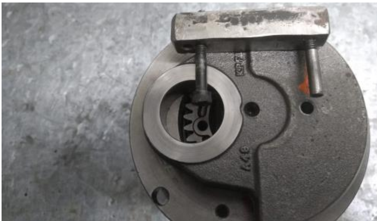
Imagem 5 – detalhe do furo na bolacha do virabrequim com ferramenta de saque
