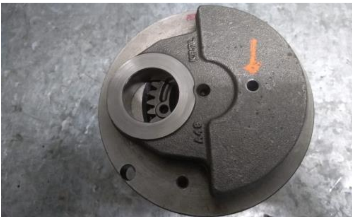
Imagem 4 – detalhe do furo na bolacha do virabrequim
