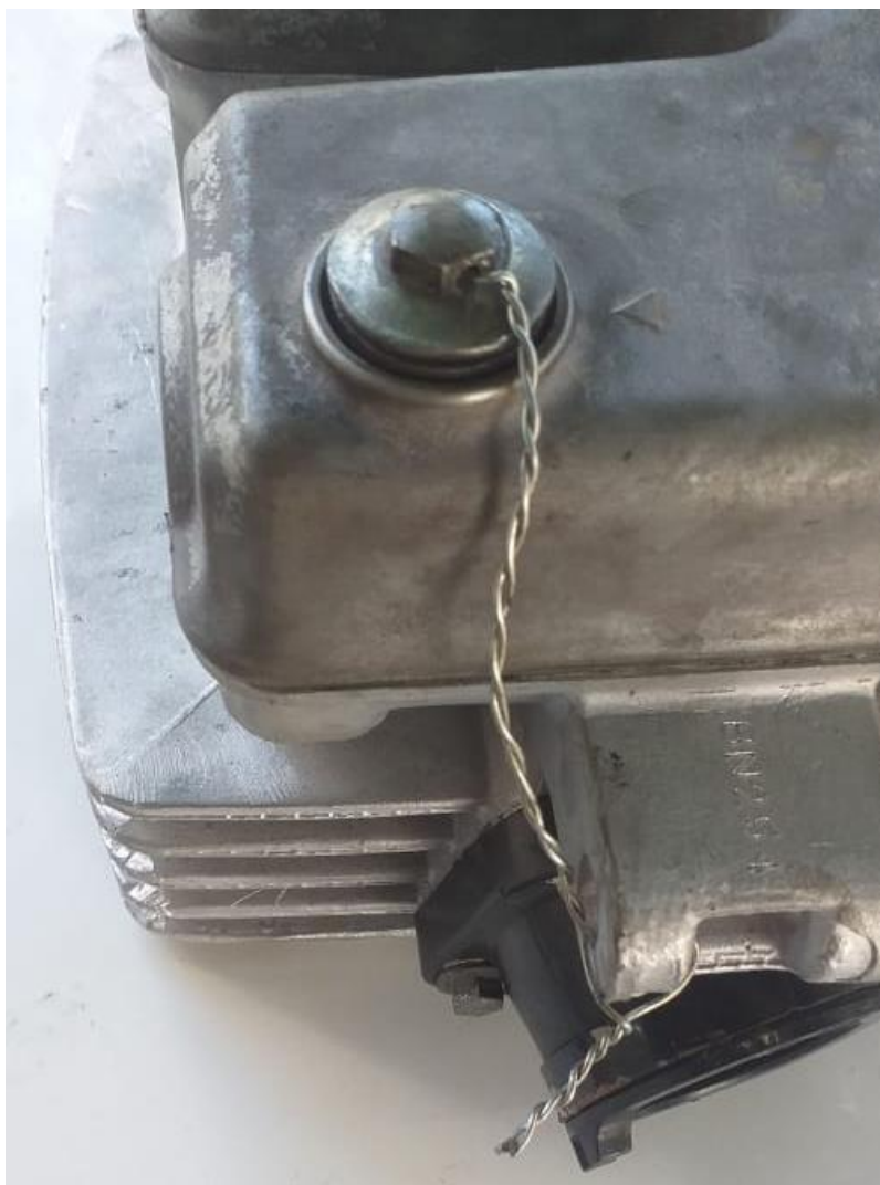
Imagem 3 – Detalhe furo passante no parafuso do cabeçote
