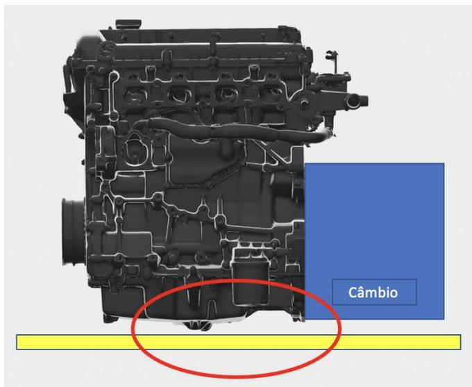
Com o elastômero padrão fixado, qualquer ponto do powertrain (motor e câmbio) não poderá estar a uma altura menor que 10 mm da face inferior do agregado.
