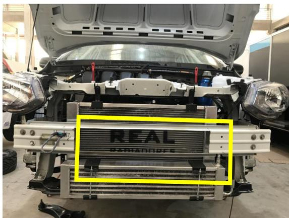
**Radiador de água pertence ao kit fornecido inicialmente pela AudaceTech, mas terá vida útil limitada em função do estado que se encontrar ao final de cada etapa. Radiadores com os trocadores de calor amassados deverão ser substituídos.**
