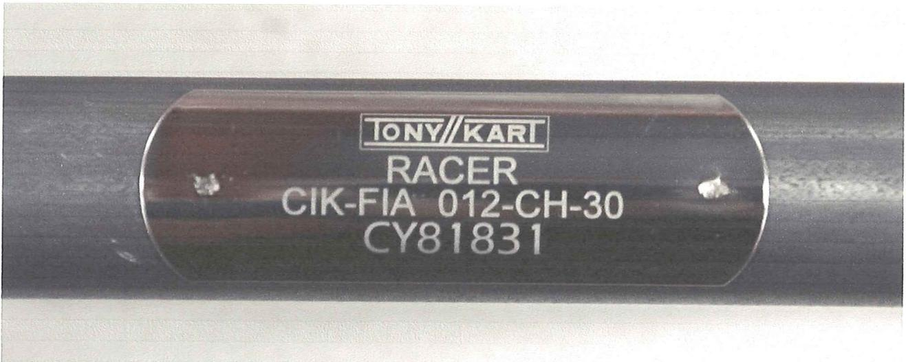
Le marquage indiqué sur le tube transversal arrière doit rester clairement visible en permanence.
