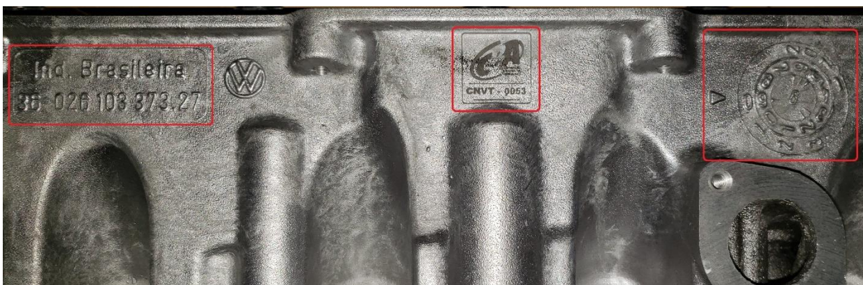
Imagem 15 – indicação dos pontos de identificação do cabeçote
