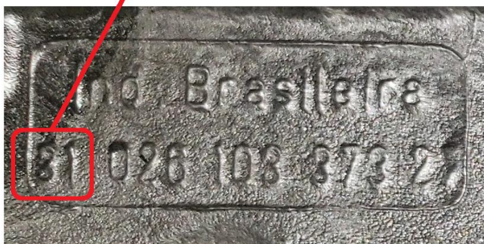
Imagem 3 – ilustra o código de identificação dos cabeçotes da série 31
