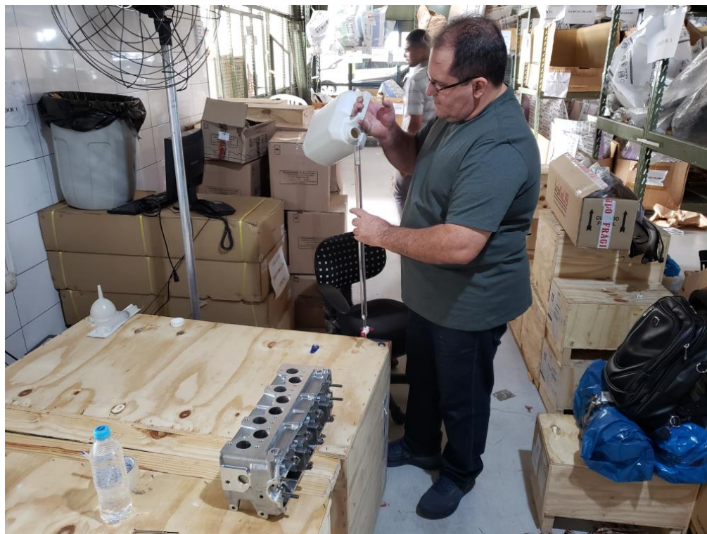
Imagem 7 – abastecimento da bureta graduada para aferição de volume
