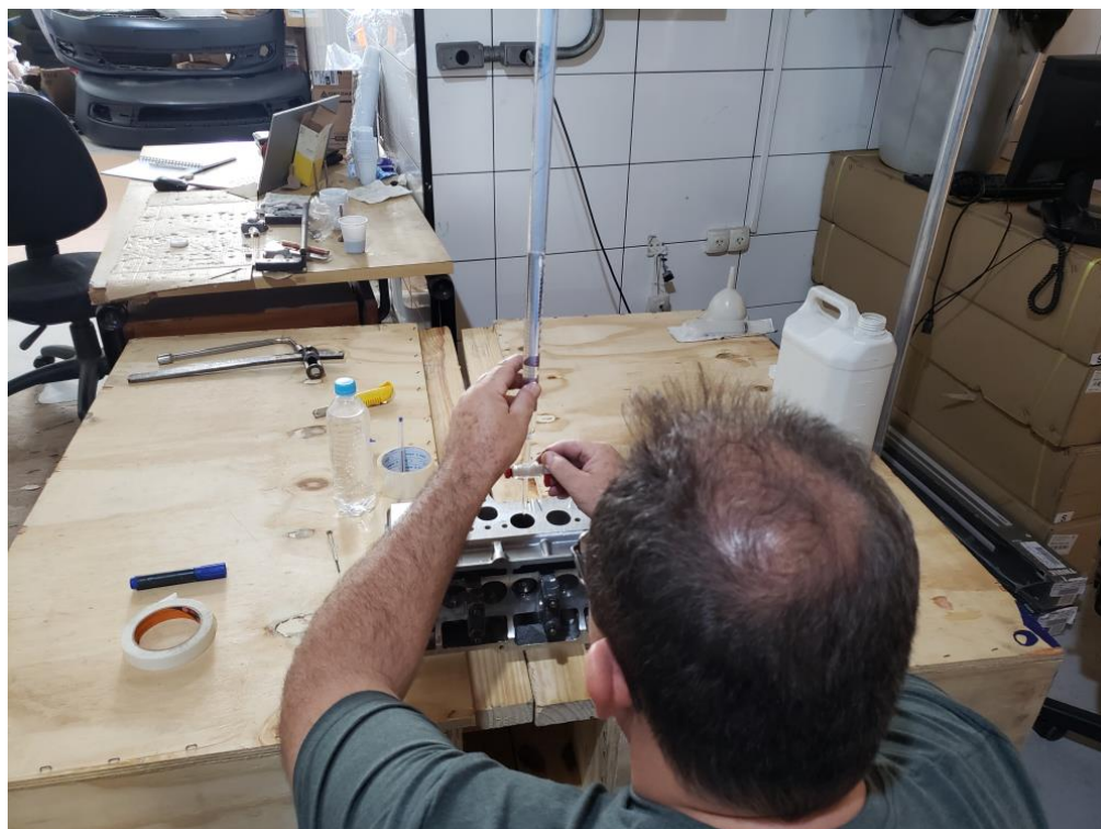
Imagem 8 – aferição de volume com auxílio de bureta graduada
