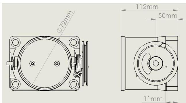
i) A medida permitida entre a base do corpo de borboleta e o conjunto eixo borboleta é de no máximo 5 centímetros.
