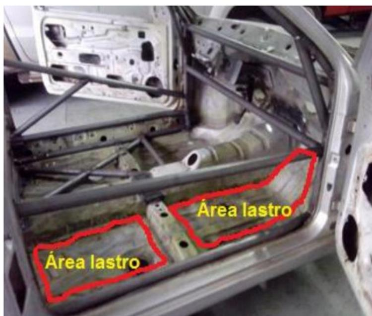
Imagem 1 – detalhamento da posição do lastro
