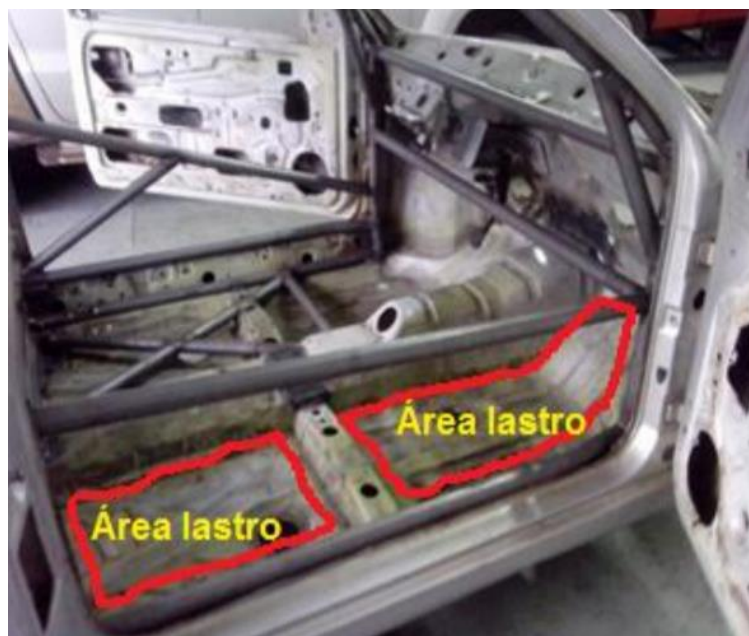
Imagem 1 – detalhamento da posição do lastro
