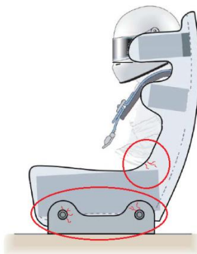
Fig. 03 – Pontos mais comuns de falhas (trincas) nos bancos
