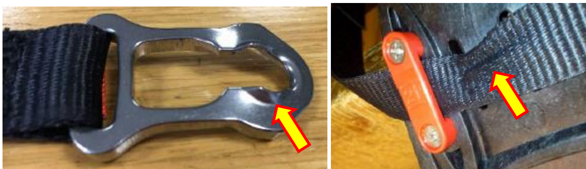
Fig. 20 – Exemplos de danos encontrados após acidentes. No lado esquerdo, deformação do ponto de ancoragem da tira no capacete; no lado direito, estiramento da retenção.
